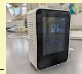
換気を確認するCO 2 モニター
