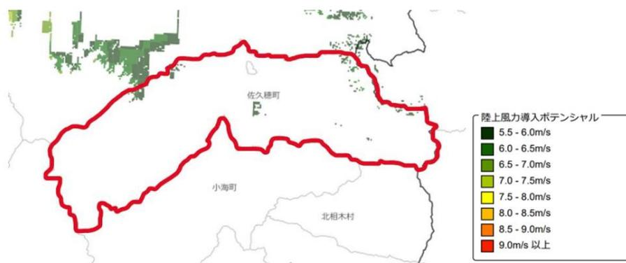
REPOS の風力発電の導入ポテンシャル(設備容量)については、全国の高度90m における風速が 5.5m/s 以上のメッシュに対して、標高などの自然条件、国立・国定公園等の法制度、居住地からの距離などの土地利用状況から設定した推計除外条件を満たすものを除いた設置可能面積に単位面積当たりの設備容量を乗じて算出されています。
