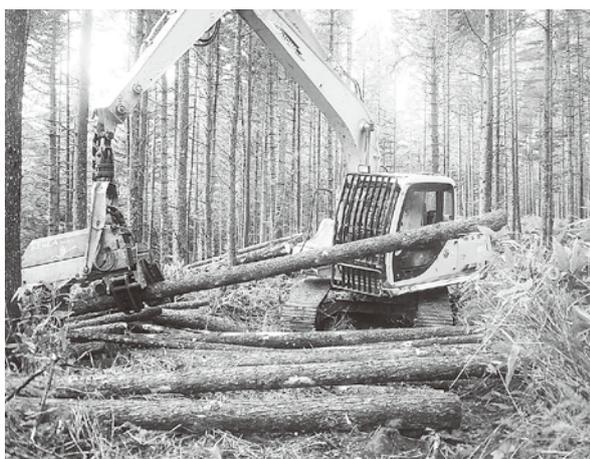
これは毎年20ヘクタールから30ヘクタールを3地区に分け更新を行う計画で、高性能機械による伐採・造材作業や車両系機械による搬出、植栽作業をはじめとする主伐・再造林を行っています。
