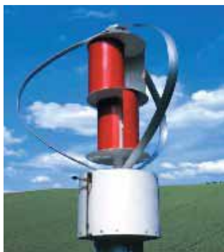
図 3.3-14 ダリウス型（外側）＋サボニウス型（内側）のハイブリッド型風車
