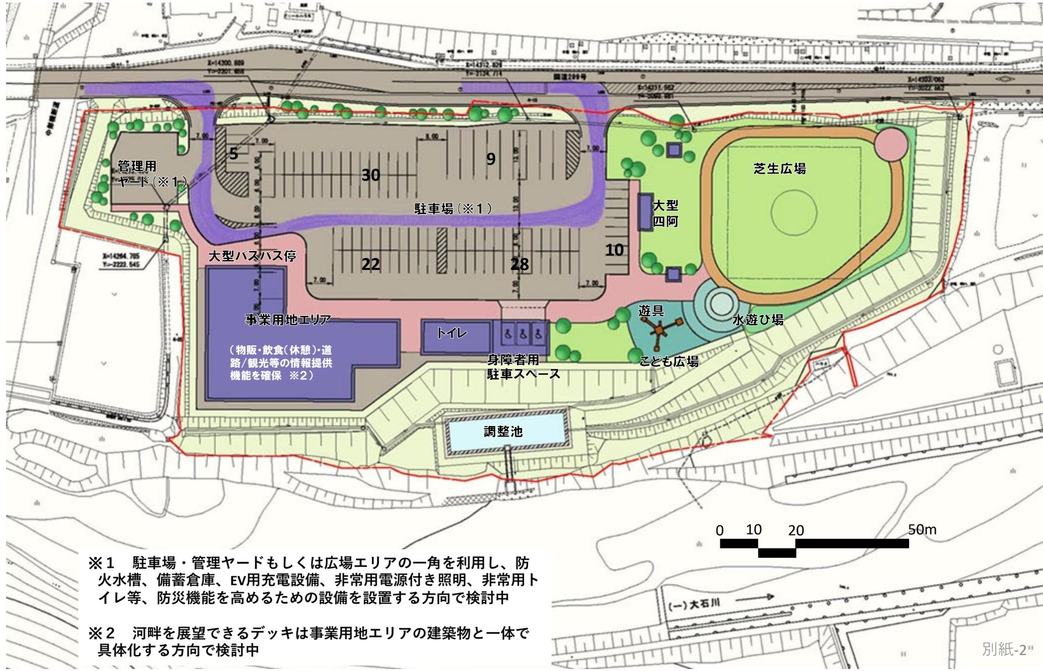
※1 駐車場・管理ヤードもしくは広場エリアの一角を利用し、防火水槽、備蓄倉庫、EV用充電設備、非常用電源付き照明、非常用トイレ等、防災機能を高めるための設備を設置する方向で検討中
